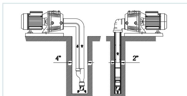
Центробежный насос с выносным эжектором предназначен для подъема воды с глубины более 10 м. Подъем воды осуществляется с помощью двух труб: всасывающей и обратной, на концы которых накручивается эжектор. Диаметр скважины не меньше 4". При установке насоса на скважину 2", необходим специальный эжектор 2" с герметическим затвором на скважине, который монтируется на всасывающую трубу, оставшееся пространство между скважиной и трубой используется как второй рециркуляционный трубопровод.
